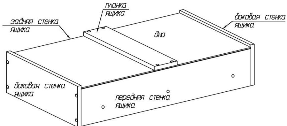
Выдвижной ящик вставляется под наклоном, сверху в выдвинутые направляющие шины. Два отверстия в задней стенке принимают задние крюки. Придавливая выдвижной ящик вниз, его соединяют с цапфами, которые должны войти в отверстия в нижней кромке боковых стенок ящика. Положение ящика по высоте настраивают винтом, расположенным под нижней кромкой бока ящика.
