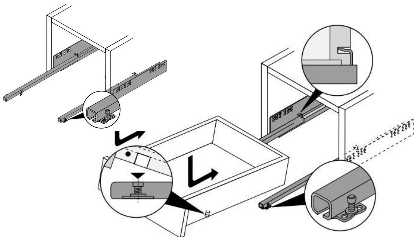
Бесступенчатое регулирование по высоте до +5мм:
