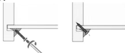
6. Установить комод на место и отрегулировать высоту ножек через отверстия в нижнем щите.
