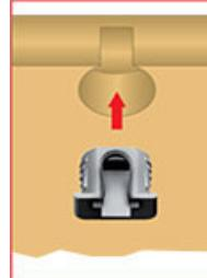
4. Установить винты M6x14 в муфты на спинках. Винты необходимо ввинтить не до конца, оставив 3-4мм для установки кроватных стяжек. На нижней кромке установить по два подпятника
